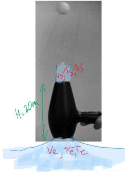
Il s'agit d'un système ouvert, avec une entrée et une sortie. En supposant le régime stationnaire, le premier principe industriel donne :  $D_m [h + e_c + e_p]_e^s = P_{\text{sèche-cheveux}}$  avec  $D_m = \text{cst}$
