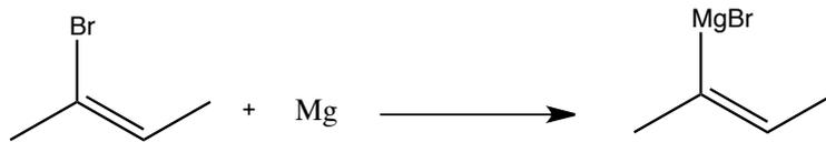
Afin d'obtenir un milieu rigoureusement anhydre, on place la verrerie et magnésium à l'étuve, le réfrigérant est surmonté d'une garde à chlorure de calcium anhydre et les réactifs sont anhydres (solvant conservé sur tamis moléculaires ; magnésium à l'étuve).
