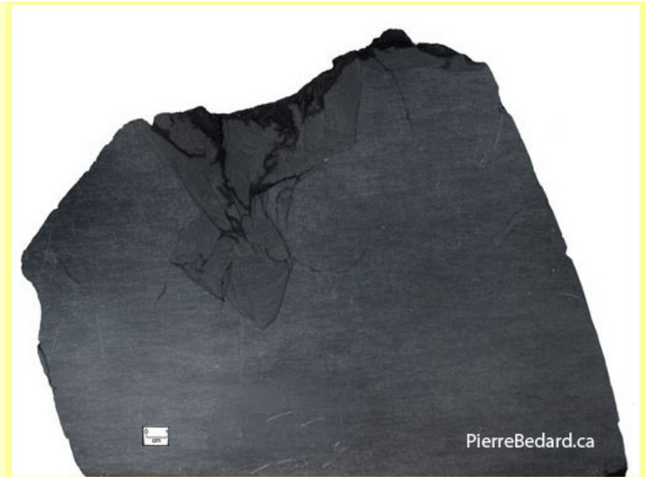
photo 3 Ardoise noire uniforme et montrant un clivage parfait. Cette qualité d'ardoise, libre d'oxydes de fer, était recherchée pour la fabrication de bardeaux de toiture et des anciens tableaux noirs.
