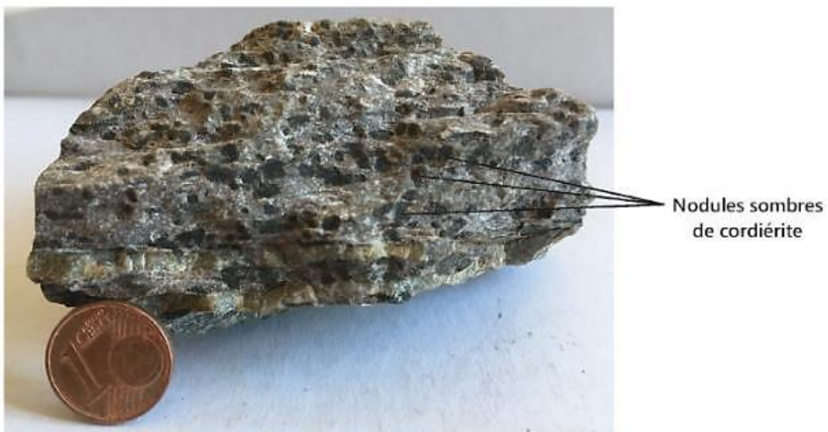
Figure 5. Une observation de la roche 3 prélevée dans la vallée d'Andlau. Cette roche n'est pas rayable à l'ongle ou à l'acier, mais raye le verre. Elle renferme, en plus des nodules, du quartz, de la biotite, de la muscovite et de la magnétite.
