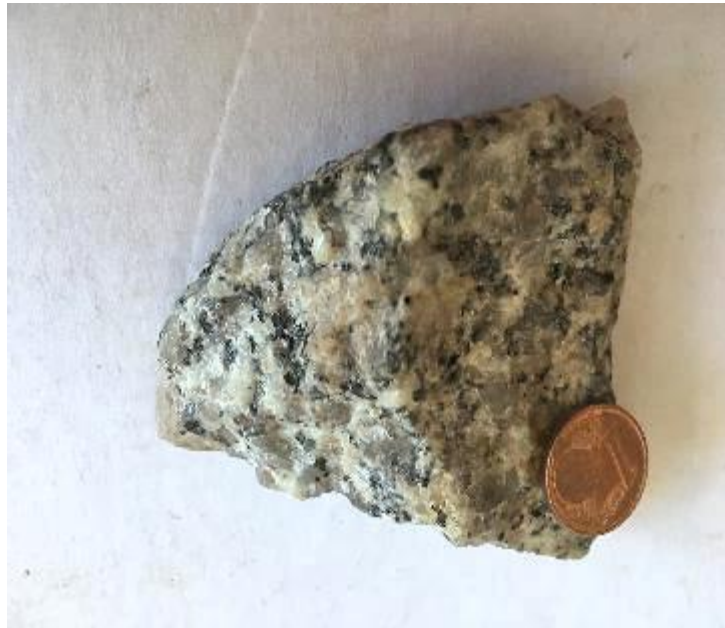
Figure 2. Une observation de la roche 1 prélevée dans la vallée d'Andlau. Cette roche n'est pas rayable à l'ongle ou à l'acier, mais raye le verre. Les plagioclases sont en plus grand nombre que les feldspaths potassiques.
