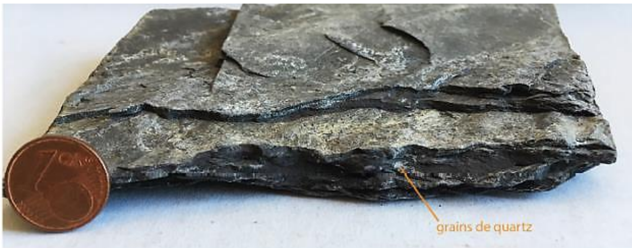
Figure 3. Une observation de la roche 4 prélevée dans la vallée d'Andlau. Cette roche n'est pas rayable à l'ongle ou à l'acier, mais raye le verre. Elle renferme du quartz, des argiles, de la muscovite et de l'hématite.
