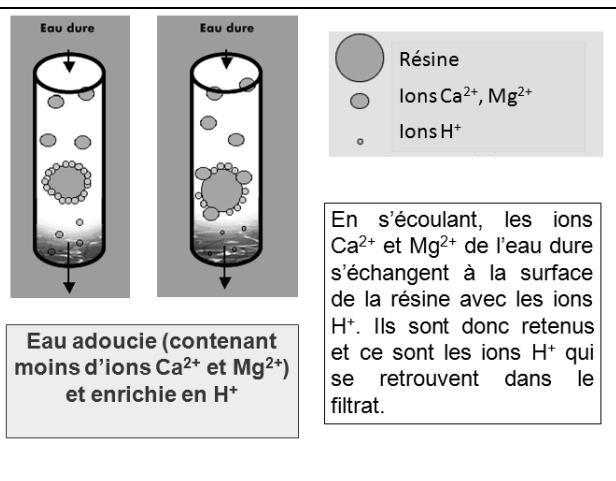
En s'écoulant, les ions Ca<sup>2+</sup> et Mg<sup>2+</sup> de l'eau dure s'échangent à la surface de la résine avec les ions H<sup>+</sup>. Ils sont donc retenus et ce sont les ions H<sup>+</sup> qui se retrouvent dans le filtrat.
