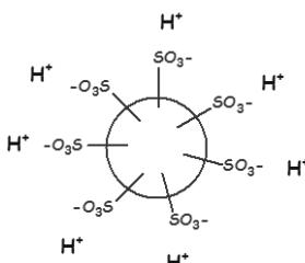
■ La résine utilisée (Amberlite IRN77) est une résine sulfonique c'est-à-dire qu'elle présente en surface des groupes sulfonate (-SO<sub>3</sub><sup>-</sup>) qui sont liés par des interactions ioniques avec des ions H<sup>+</sup>. D'autres cations peuvent également être fixés (non précisé par le fabricant).
