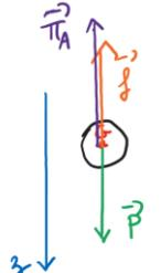
**Principe fondamental de la dynamique** :  $m\vec{a} = m \frac{d\vec{v}}{dt} = \vec{P} + \vec{\Pi}_A + \vec{f}$
