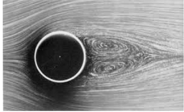
Écoulement présentant une zone turbulente
