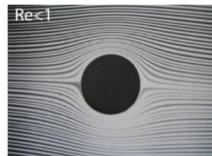
Écoulement autour d'une sphère, Re < 1
