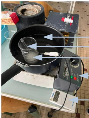
Figure 3: Matériel de synthèse utilisé
