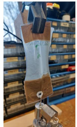
Figure 25. Ajout de masses petit à petit pour mesurer l'élongation du plastique
