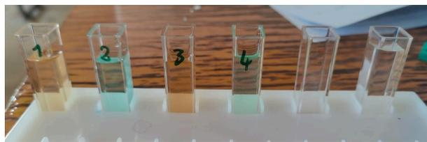
Figure 8 : Préparation des cuves contenant le blanc et les différentes solutions provenant des serres.
