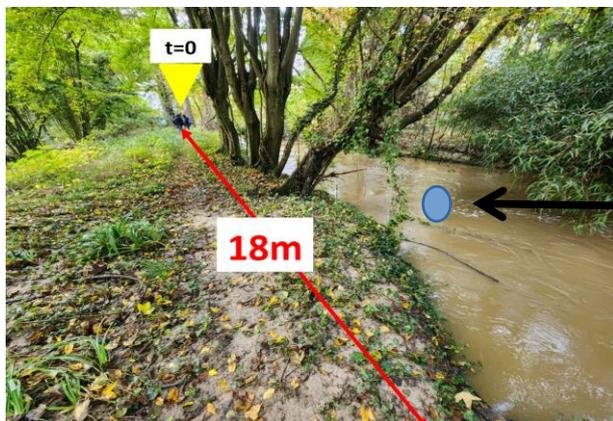
Figure 6 : Illustration de l'expérience de mesure de la vitesse, photographie de notre étude de terrain à St-Rémy-lès-Chevreuse, Site 1, (6)
