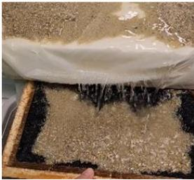
Figure 10 : Photographie du tamis permettant la collecte du sable érodé en aval de la maquette (6)
