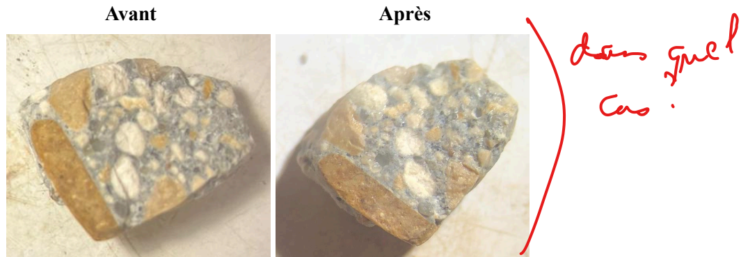
Figure 6. Observation d'un même GBR avant et après calcification à la loupe binoculaire (x6,4)
