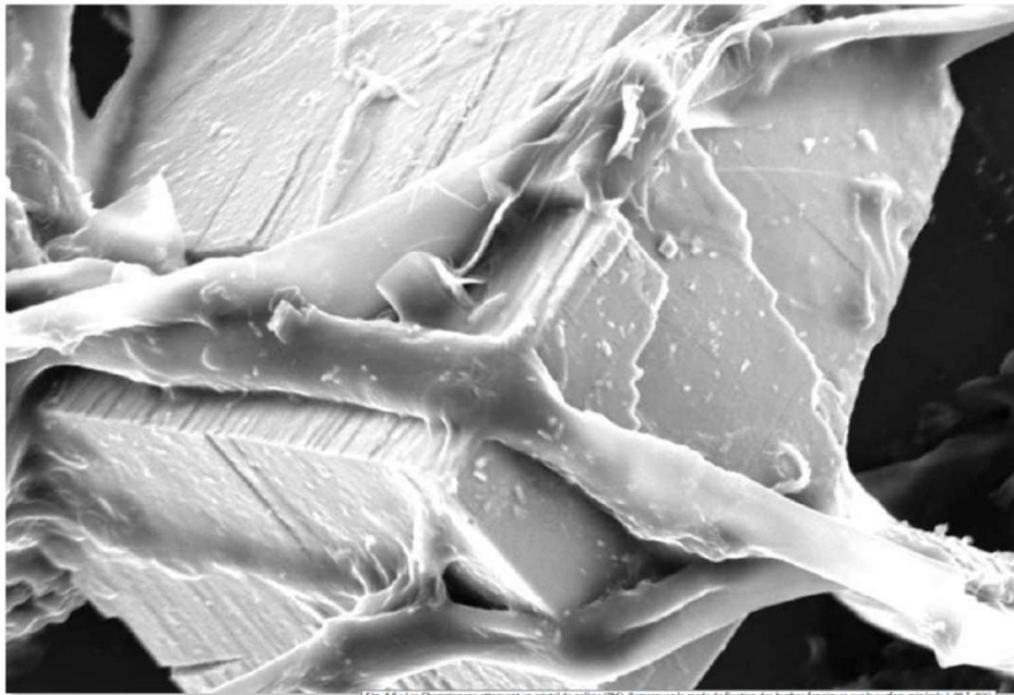
Fig. 4.6 : Les Champignons attaquant un cristal de galène (PbS). Remarquez le mode de fixation des hyphes fongiques sur la surface minérale à 90°. (XX)
