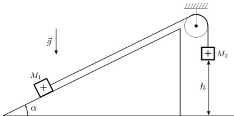
Le dispositif ci-dessus est lâché sans vitesse initiale. Les solides repérés par  $M_1$  et  $M_2$  ont une même masse  $m$ . La poulie est supposée idéale (sans frottements et de moment d'inertie négligeable). On suppose également que le solide 1 glisse sans frottements sur le plan incliné.
