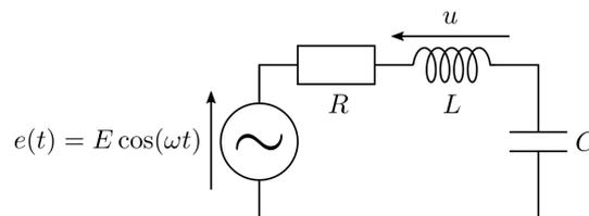
On étudie la tension  $u$  aux bornes de la bobine d'un circuit RLC série en régime sinusoïdal forcé.
