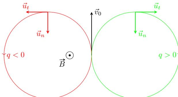
La vitesse de rotation, appelée pulsation cyclotron, est  $\Omega = \frac{v_0}{R} = \frac{|q|B}{m}$ .
