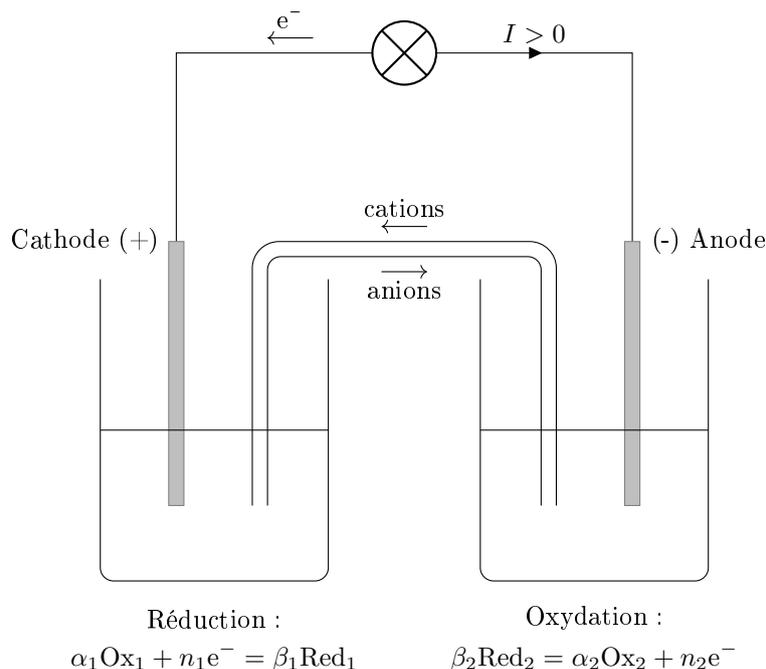
D'un point de vue électrique, une pile peut être modélisée par un **générateur de Thévenin** de force électromotrice  $E_+ - E_-$ , où  $E_+$  et  $E_-$  sont respectivement les potentiels de Nernst de la cathode et de l'anode.
