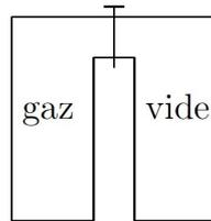
On considère une enceinte à deux compartiments de même volume  $V_0$ , aux parois calorifugées et indéformables pouvant communiquer au moyen d'un robinet. A l'état initial, le compartiment de gauche contient une quantité  $n$  de gaz parfait à la température  $T_0$ , le compartiment de droite est vide. On ouvre alors le robinet.
