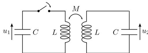
On considère deux circuits LC couplés par induction mutuelle. Le condensateur 1 est initialement chargé sous une tension  $E$ . A l'instant  $t = 0$ , on ferme l'interrupteur.
