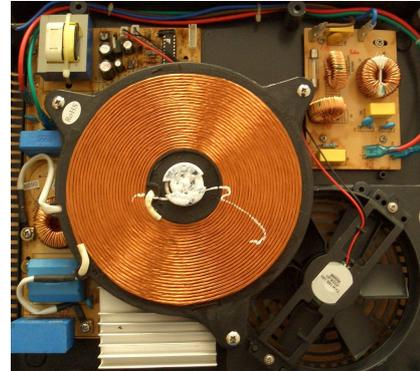
On modélise le circuit de la plaque de cuisson, par une bobine d'inductance  $L_1$  et de résistance  $R_1$ , alimentée par un générateur de tension  $e(t) = E \cos(\omega t)$ . Le fond de la casserole est modélisé par un circuit d'inductance  $L_2$  et de résistance  $R_2$ . On note  $M$  l'inductance mutuelle entre le circuit de la plaque et le fond de la casserole.
