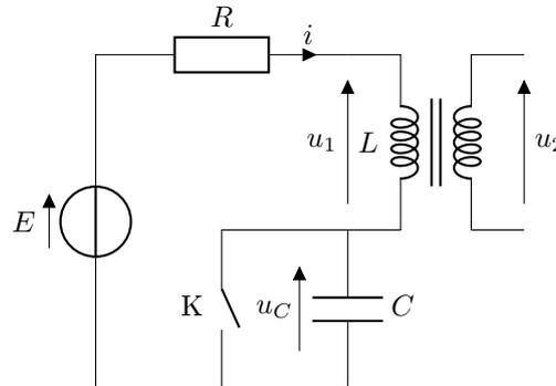
La batterie, modélisée par une source idéale de tension  $E = 12 \text{ V}$ , alimente l'enroulement primaire d'un transformateur, modélisé par une inductance  $L = 5 \text{ mH}$  et une résistance  $R = 5 \text{ }\Omega$ . Le circuit comprend un interrupteur K, appelé rupteur, dont l'ouverture et la fermeture sont synchronisées avec la rotation du moteur. Un condensateur de capacité  $C = 0,2 \text{ }\mu\text{F}$  en parallèle du rupteur permet de protéger ce dernier.
