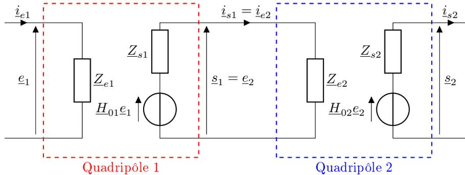
La fonction de transfert du filtre global est  $\underline{H} = \frac{\underline{s}_2}{\underline{e}_1}$ .
