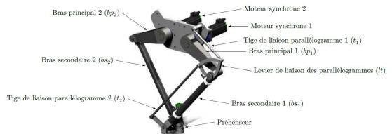
On donne l'équation de fonctionnement du moteur :  $\tau \cdot \frac{d\omega(t)}{dt} + \omega(t) = K_1 \cdot u_m(t)$
