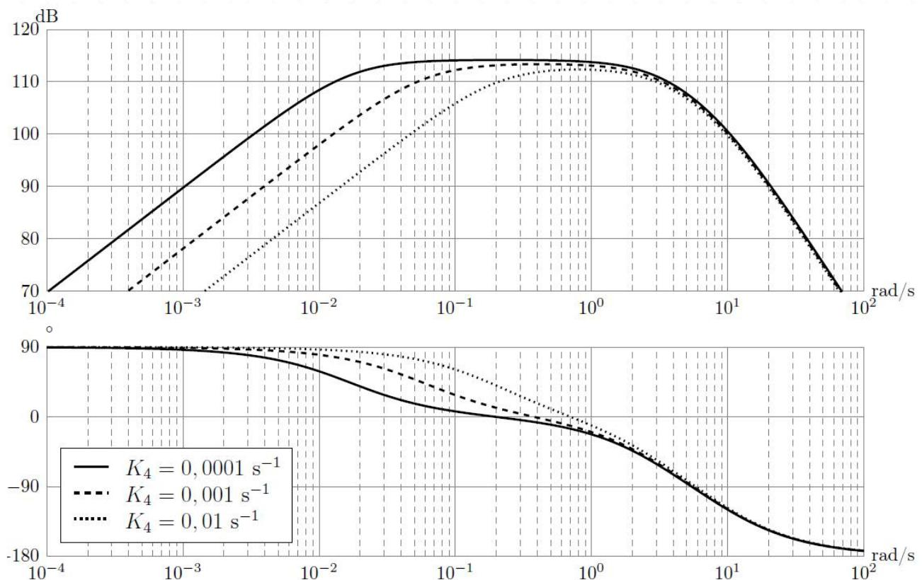
**Q2** Choisir la valeur de  $K_4$  qui permet de vérifier au mieux les exigences 3.3 et 3.4. Donner le nom du filtre réalisé. Préciser l'intérêt de cette solution pour la mesure des séismes.
