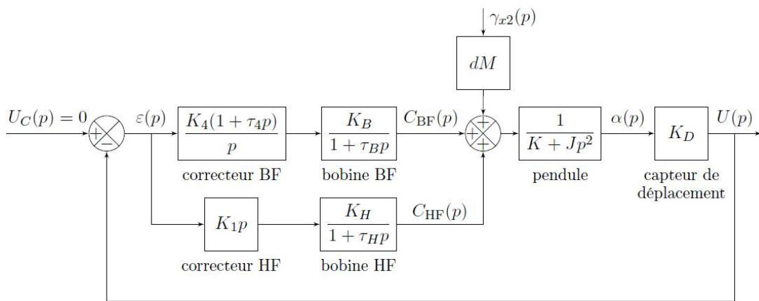
L'asservissement mis en place est donc une régulation devant permettre d'annuler en régime permanent les effets des secousses sismiques sur le pendule, tout en étant sensible aux signaux dans une large bande de fréquences d'ondes sismiques, entre 0,01 Hz et 0,5 Hz.
