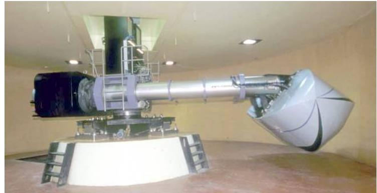
Le bâti (1) est fixe. Le solide (2) est animé d'un mouvement de rotation d'axe  $(O_1, \vec{z}_1)$  et d'angle  $\varphi$  par rapport au bâti (1). Ces solides sont liés par une liaison pivot.
