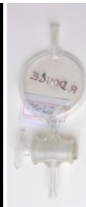
Fig. 15 : Dispositif expérimental utilisé dans l'expérience de Calvin-Benson ©encyclopedie-environnement.org
