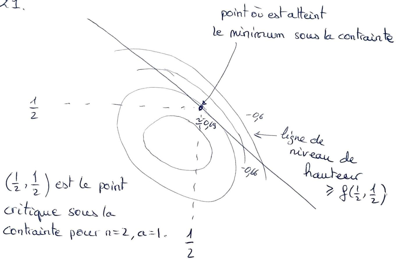
On constate qu'au niveau de  $(\frac{1}{2}, \frac{1}{2})$ , la droite représentant la contrainte est tangente à la ligne de niveau. Ce qui est bien confondre avec le fait que le gradient au niveau du point critique est à la fois orthogonal à la ligne de niveau et à la droite. C'est-à-dire colinéaire au vecteur  $\nabla g$  qui est normal à la droite.
