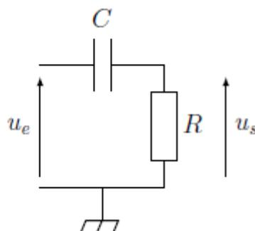
1. Pour supprimer la valeur moyenne, quelle fréquence faut-il éliminer dans le signal ? Parmi les deux circuits, en utilisant des schémas équivalents à haute puis basse fréquence, lequel permet d'effectuer l'opération recherchée ?
