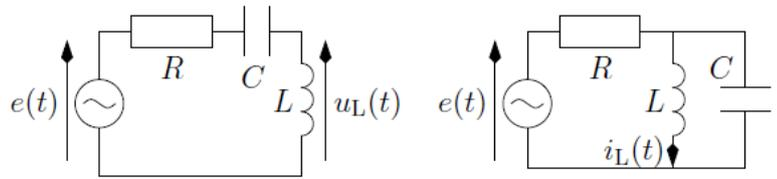
1. Dans le premier circuit, déterminer à l'aide de schémas équivalents la tension  $u_L(t)$  aux bornes de la bobine, dans les cas limite où  $\omega \rightarrow 0$  et  $\omega \rightarrow \infty$ .
