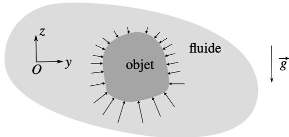
Dans un référentiel  $\mathcal{R}$ , la poussée d'Archimède est la résultante des forces de pression exercées sur un objet immobile dans  $\mathcal{R}$ , par l'ensemble des fluides au repos qui l'entourent.
