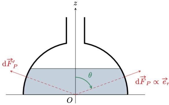
Autour du point  $M$ , l'élément mésoscopique qui subit la force pressante est de normale  $\vec{e}_r$  et donc de surface  $dS = R d\theta \times R \sin \theta d\varphi$ . En tenant compte de l'eau à la pression  $P(z)$  et de l'air à la pression  $P_0$ , la composante utile de la force infinitésimale qu'il subit est donc
