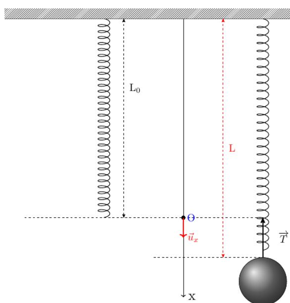
Contrairement à une corde, un ressort est élastique : il a la capacité de se déformer lorsqu'on exerce une contrainte, et de reprendre sa forme initiale lorsqu'on supprime la contrainte.
