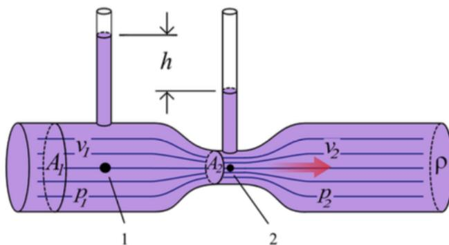
Un fluide supposé incompressible s'écoule dans le tube, et on se place en régime stationnaire.
