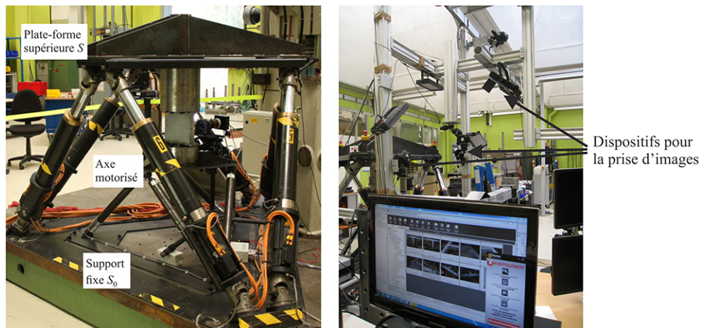
FIGURE 1 – Système d'asservissement en position d'un Hexapode par traitement d'images
