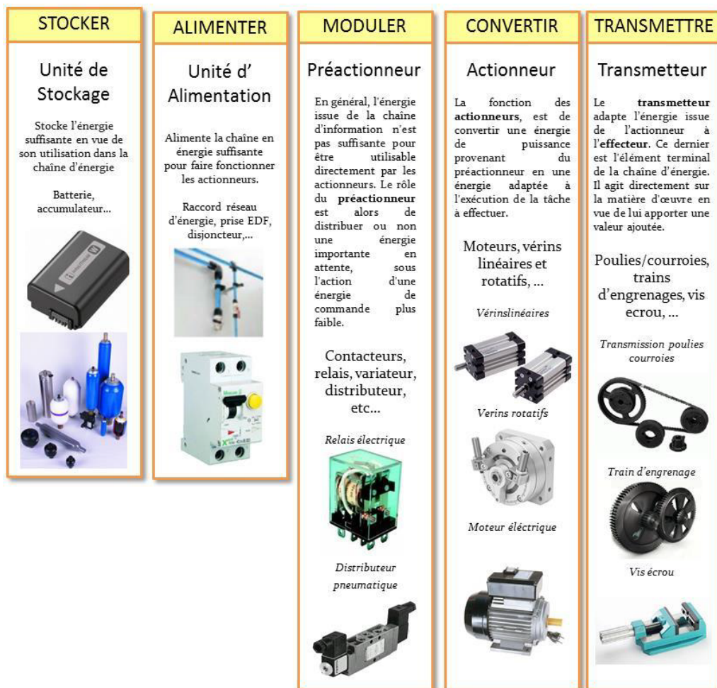
FIGURE 7 – Constituants de la chaîne d'énergie
