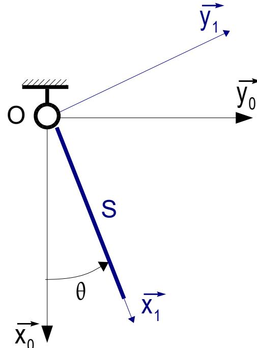
Écrire les équations issues du PFD appliqué à la barre S, homogène, de rayon négligeable, de masse m, de longueur L. On suppose que  $(O, \vec{x}_0, \vec{y}_0, \vec{z}_0)$  est un référentiel galiléen et la pesanteur est telle que  $\vec{g} = g \vec{x}_0$ .
