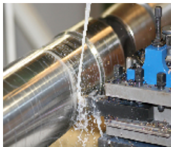
(a) Tournage : rotation de la pièce, translation de l'outil
