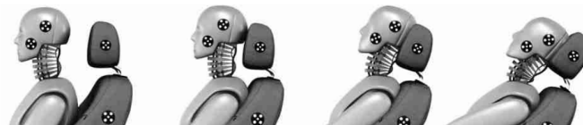
FIGURE 1 – Réduction du phénomène du « coup du lapin » par l'usage d'un appui-tête (Référence : R.T. Shone).
