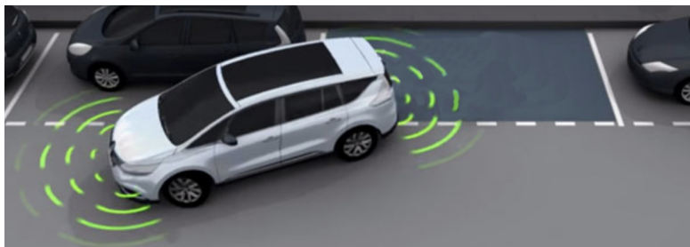
Figure 1 Détection par ultrasons (4 capteurs)
