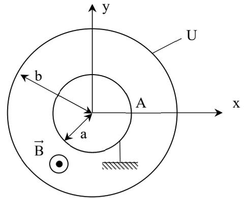
On cherche à décrire les phénomènes qui ont lieu à l'intérieur du condensateur en présence d'un champ magnétique uniforme, lorsqu'on émet, depuis un point A situé sur l'armature centrale, des électrons avec une énergie cinétique négligeable. Pour cela, on associe au référentiel du condensateur un repère orthonormé direct (Oxyz), (Ox) étant l'axe normal à (Oz) passant par A et on choisit d'utiliser les coordonnées cylindriques d'axe (Oz).
