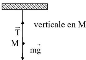
La direction de  $\vec{g}(M)$  définit la direction de la verticale en M ( direction du fil à plomb : dans le cas de la figure ci-contre  $\vec{f} = \vec{T}$  tension du fil )
