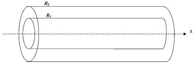
On a :  $R_1 = 0,25 \text{ mm}$  ,  $R_2 = 1,25 \text{ mm}$  ,  $\ell = 100 \text{ m}$ . On note  $(\vec{u}_r, \vec{u}_\theta, \vec{u}_z)$  la base en coordonnées cylindriques.
