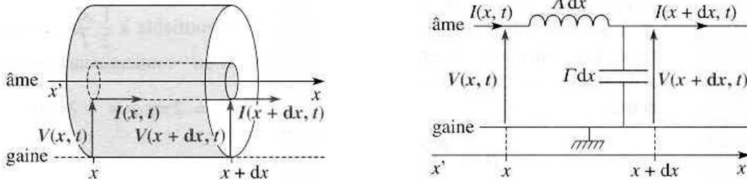
$\Lambda$  et  $\Gamma$  sont respectivement l'inductance et la capacité par unité de longueur du câble. L'ensemble du câble est ainsi modélisé par une succession de cellules électriques identiques, comme suit (on parle de « modèle à constantes réparties ») :
