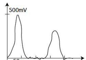
Commenter l'oscillogramme obtenu et calculer la vitesse de propagation de l'onde dans le câble.
