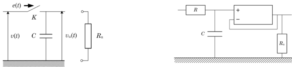
FIGURE 8 – À gauche : échantillonneur bloqueur ; la résistance R_u modélise le circuit d'utilisation. À droite : échantillonneur bloqueur avec AO parfait. La résistance R représente l'ensemble des résistances en amont, lorsque l'interrupteur est fermé.
