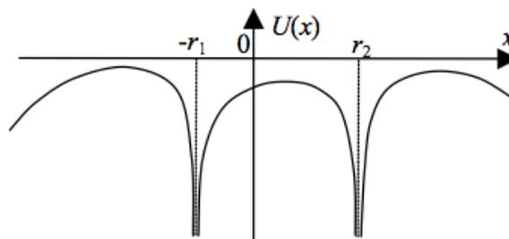
Il y a 3 extrema d'énergie potentielle donc trois positions d'équilibre : une entre  $m_1$  et  $m_2$ , deux de part et d'autre. Ces positions sont instables par rapport à un déplacement selon  $x'Cx$  (maximum local d'énergie potentielle).
