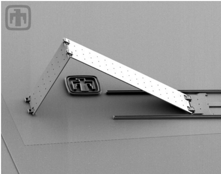
*Micro-miroir pliable commandé par une tension :*
