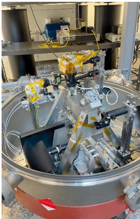
Pour tester la faisabilité d'une balance à fléau aussi sensible, les chercheurs ont d'abord conçu un prototype, légèrement plus petit et plus simple que la structure finale.
