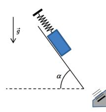
On place un parallélépipède sur un plan très incliné ( $\alpha$  voisin de 75°). Il est retenu par un ressort. Ses oscillations vont être suivies par le capteur de position à ultra-sons (bien orienter son haut-parleur).
