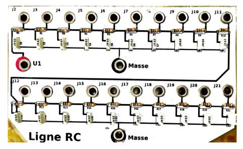
Il est possible de faire des mesures de tension aux bornes de chaque capacité. Le schéma électrique du dispositif expérimental est le suivant :
