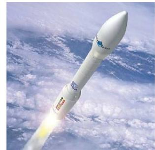
1. En effectuant un bilan de quantité de mouvement entre  $t$  et  $t + dt$  pour le système {gaz +fusée} dans le référentiel galiléen du sol, montrer que la fusée et son contenu sont soumis à l'analogie d'une force, appelée force de poussée :  $\vec{\Pi} = -D_m\vec{u}$
