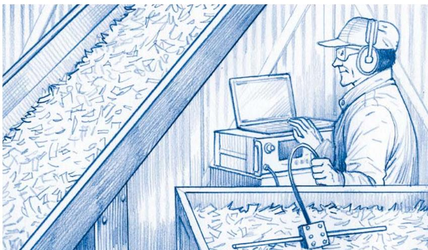
dans le matériau, ou de leur réflexion, transmission et pénétration au niveau de sa surface. Du bois humide et du bois sec soumis au même rayonnement – des ondes hertziennes en pratique – se distingueront ainsi par leur réponse électromagnétique.
