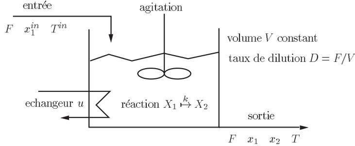
FIGURE 2.2. Un réacteur chimique exothermique où  $u$  correspond aux échanges thermiques avec l'extérieur
