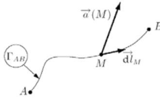
FIGURE 1.4 – Schéma explicitant le calcul de la circulation d'un champ  $\vec{a}$  le long d'un contour  $\Gamma$  reliant deux points  $A$  et  $B$ .
