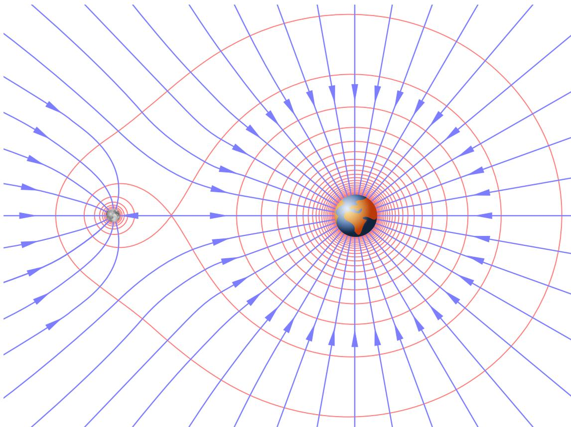
FIGURE 1.5 – Lignes de champ et équipotentiels du système Terre-Lune, qui peuvent être calculées via le principe de superposition. Le champ de gravité est plus fort là où les équipotentiels et les lignes de champ sont les plus resserrées. Le champ est le gradient du potentiel, ainsi les lignes de champ et les équipotentiels sont en tout point perpendiculaires. Source : Wikimedia Commons.
